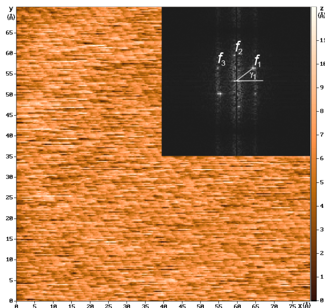
Рис. 3. Атомарное разрешение на поверхности грани канала коробчатой наноструктуры (режим постоянного тока). Направление быстрого сканирования – ось x . На вставке дан фурье-спектр, на котором можно наблюдать 6 типичных для графита максимумов. Шестиугольник, состоящий из 6 максимумов, сильно искажён термодрейфом и остаточными деформациями решётки. Максимумы пространственных частот: f_1=1/2.1 \text{ \AA}^{-1} , f_2=1/1.6 \text{ \AA}^{-1} , f_3=1/2.1 \text{ \AA}^{-1} . Направления распространения пространственных частот: \gamma_1=41.1^\circ , \gamma_2=94.7^\circ , \gamma_3=148.0^\circ .
